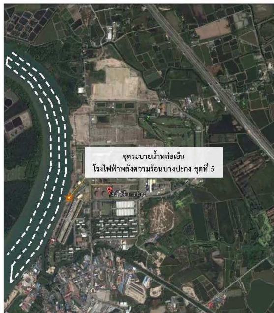
รูปที่ ง-5 แผนที่เส้นทางการตรวจวัดการแพร่กระจายอุณหภูมิน้ำหล่อเย็นในแม่น้ำบางปะกง
